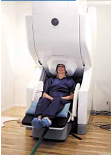
Au centre de recherche NeuroSpin de Saclay, un appareil de magnétoencéphalographie, financé par la Fondation, permet de visualiser avec précision la dynamique du cerveau.
